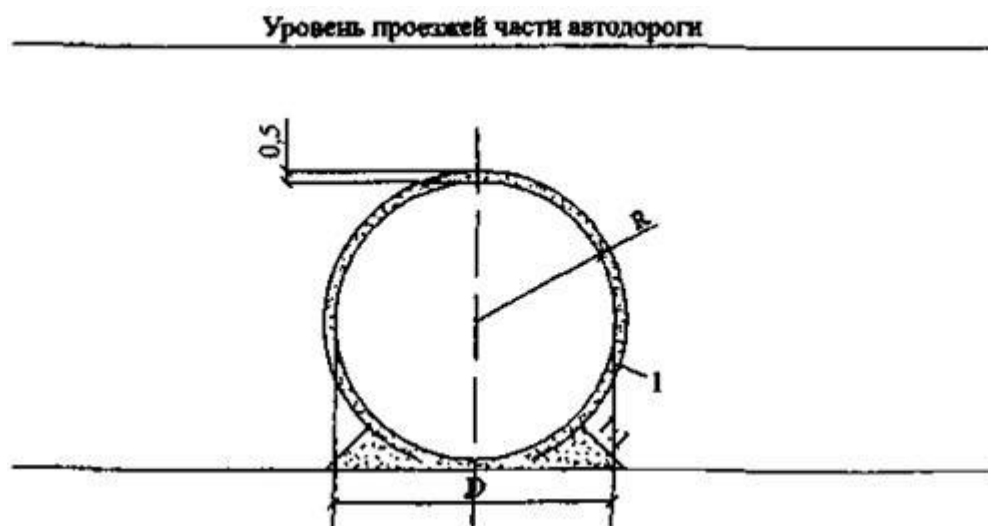
Рис. 8. Демпфирующий слой из песчано-гравийного или щебеночного грунта
