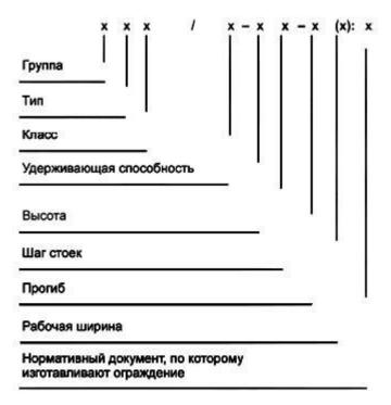
4.5 Группа удерживающего недеформируемого бокового ограждения для автомобилей обозначается цифрой 1. Группа удерживающего деформируемого бокового ограждения для автомобилей обозначается цифрой 2.
