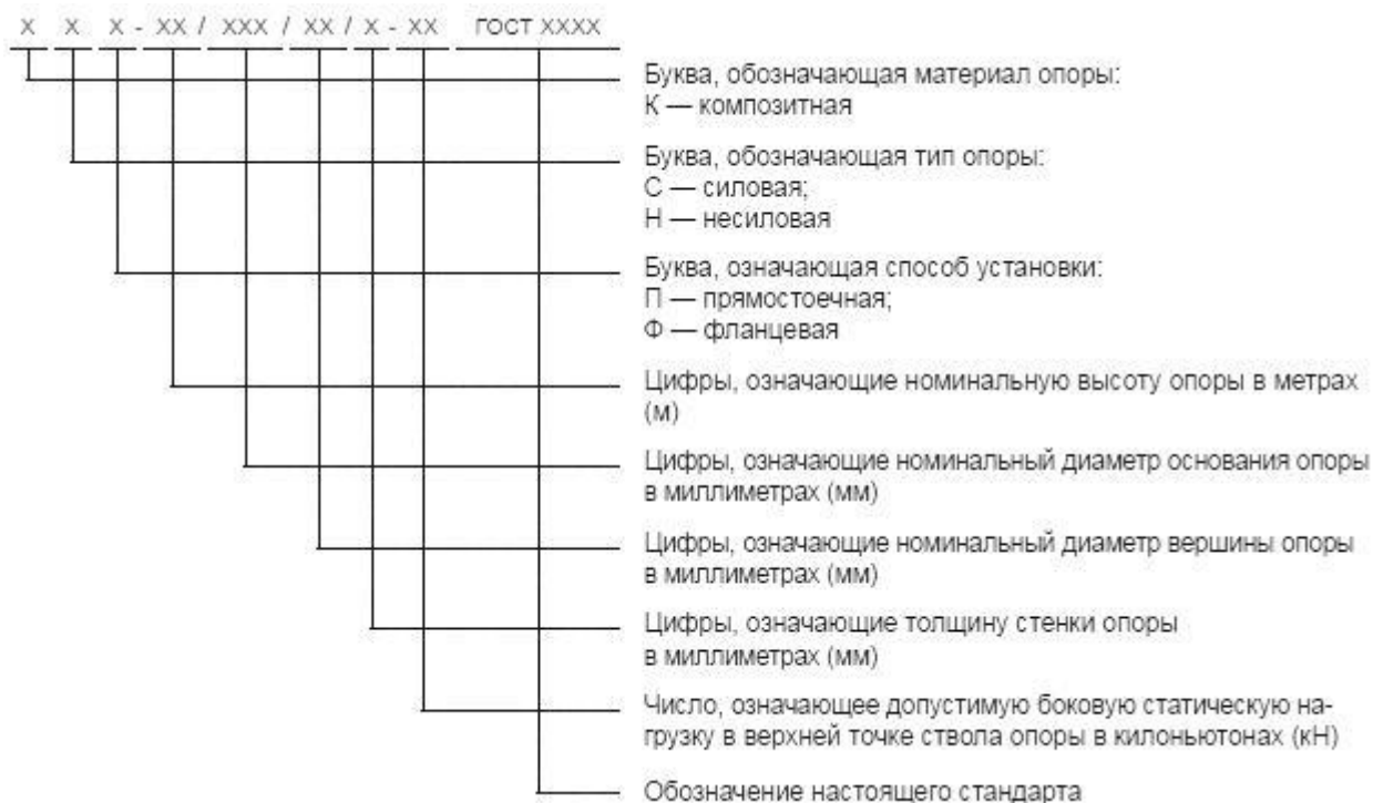
Рисунок 4.3 - Структурная схема маркировки композитных опор
